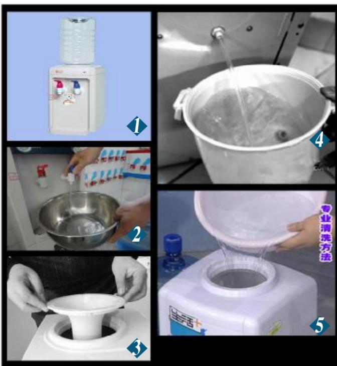
**STEP 1** 关闭电源,取下桶装水,打开两个水龙头,让饮水机里的水彻底排除。
